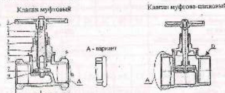
1 - шпилька; 2 - корпус; 3 - крышка; 4 - гайка сальника; 5 - ступица сальника; 6 - маховик; 7 - золотник; 8 - прокладка; 9 - прокладка золотника.
